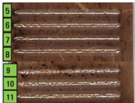
[제1 레이저빔과 제2 레이저빔의 파워 비율 따른 레이저 용접 결과 및 분석]
